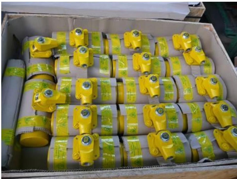
Рис. 5. Шарові крани зварного з'єднання виробництва Угорщини
