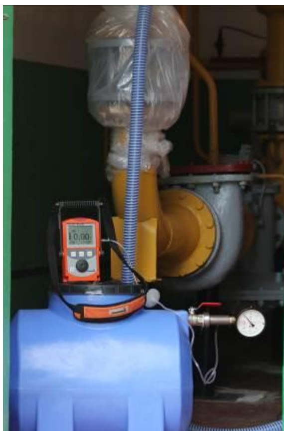
Рис. 7. Фото установки для кількісного вимірювання витоків метану
