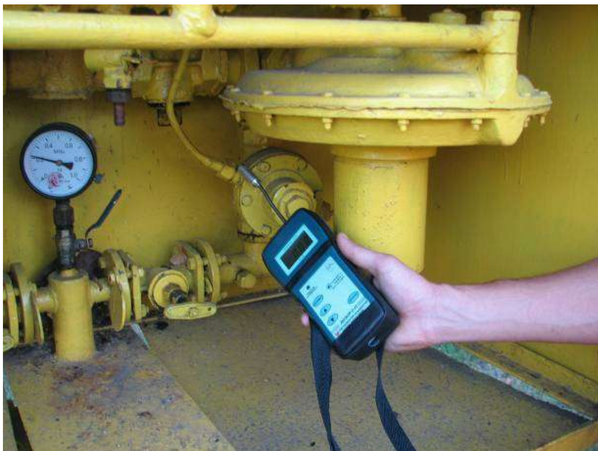
Рис. 2. Фото вимірювальних робіт з використання газоаналізатора ДОЗОР-С-П.
