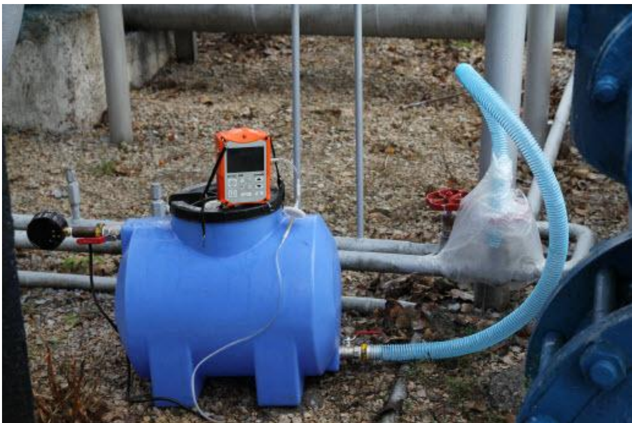
Рис. 1. Фото установки кількісного вимірювання витоків метану
