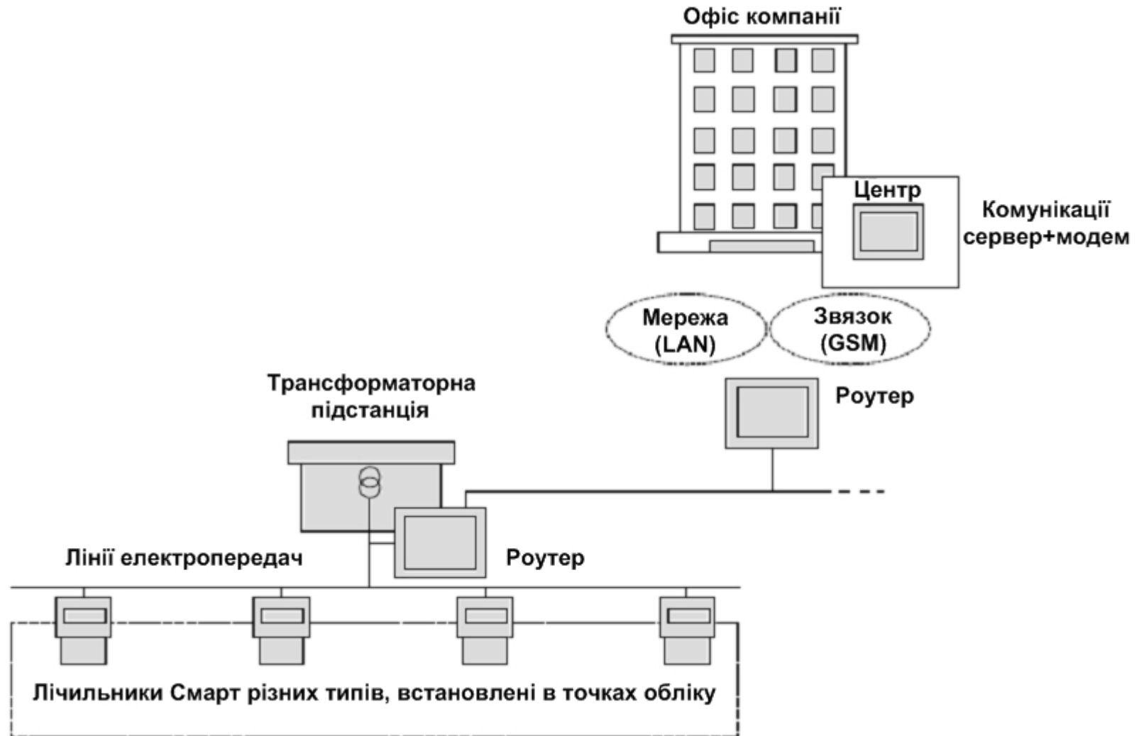
Рис. 8. Схема збору даних за допомогою автоматизованої системи комерційного обліку споживання електроенергії (АСКОЕ) периметру енергопостачальної компанії
