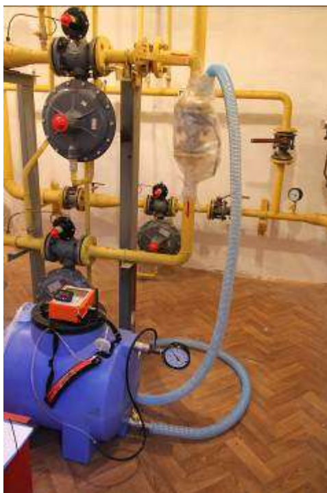
Рис. 3. Фото установки для кількісного вимірювання витоків метану
