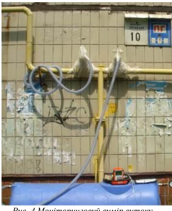
Рис. 4 Моніторинговий вимір витоку метану на клиновій засувці реєстровий № 3032 (проспект Правди, 10).
