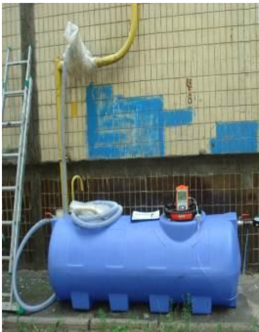
Рис. 3. Моніторинговий вимір витоку метану на клиновій засувці, реєстровий № 4020 (вул. Маршала Якубовського, 2А).
