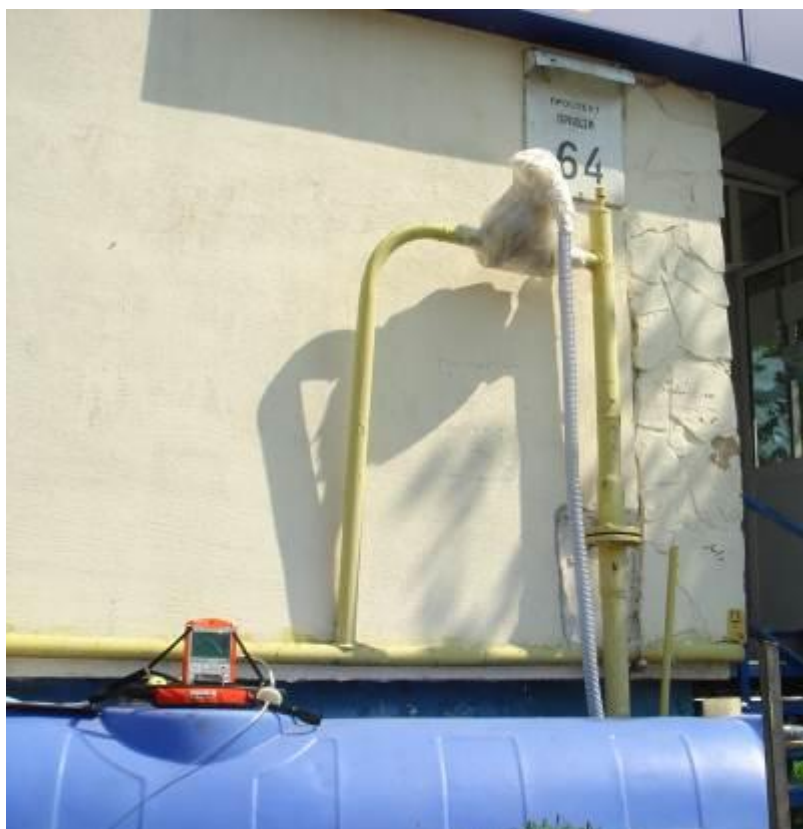
Рис. 5. Моніторинговий вимір витоку метану на клиновій засувці, реєстровий № 9945 (проспект Правди, 64)
