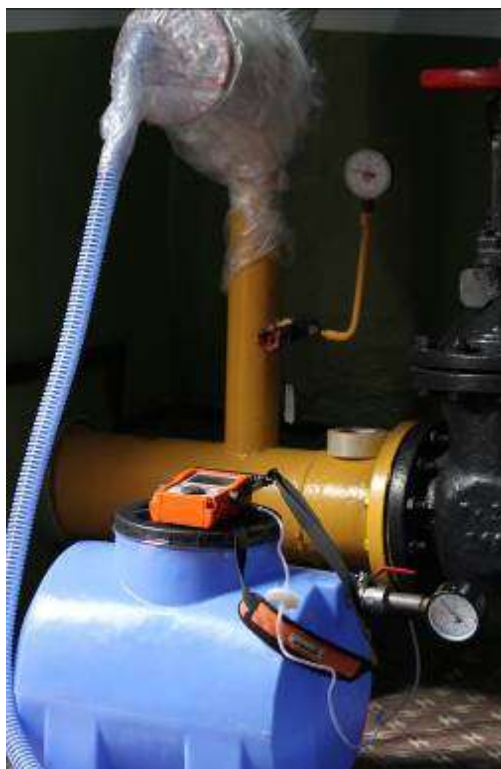
Рис. 1. Фото установки для кількісного вимірювання витоків метану
