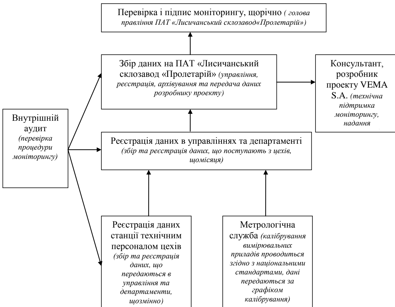
Рисунок 1 Структура збору даних моніторингу
