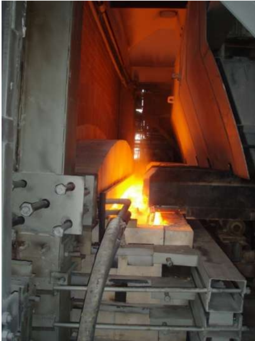
Рис. 7. Вузол подачі шихти на печі в цеху № 3.
