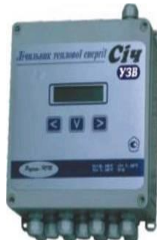
Рис.4. Лічильник теплової енергії і води (СИЧ-Узв)
