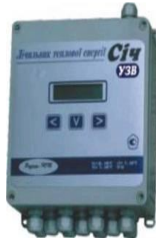
Рис.4. Лічильник теплової енергії і води (СІЧ-Узв)
