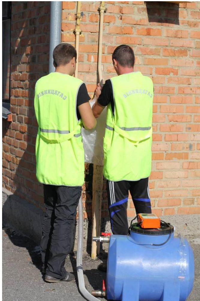
Рис. 2. Фото установки для кількісного вимірювання витоків метану.
