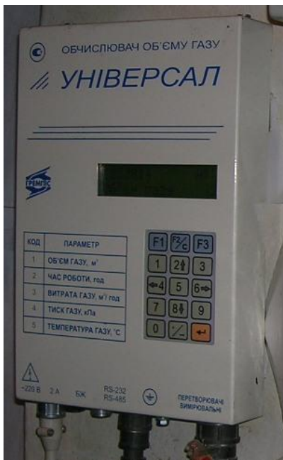
Fig. 3. Gas flow meter
